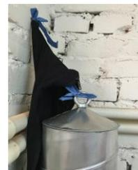
4. Прочно привяжите Крышку Запаривателя к Чехлу тесемками, находящимися внутри верхушки Чехла. При этом Корпус Запаривателя должен быть на расстоянии нескольких миллиметров от стены.
