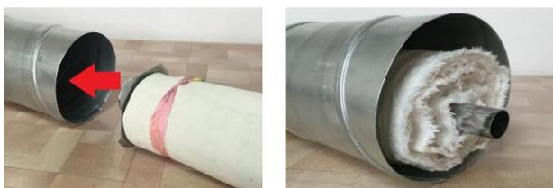
9. Вставьте Ось в верхний конец Корпуса на максимально возможную глубину.
