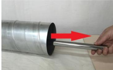
3. Приподнимите Корпус Запаривателя и положите его на стол. Вытащите Ось из Корпуса.
