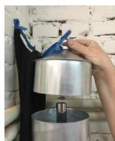
5. Удалите бумажный скотч, крепящий Крышку к Корпусу, и проверьте, что Крышка свободно вытаскивается из Корпуса. Если Крышка не вытаскивается, отвяжите ее и привяжите снова так, чтобы Корпус Запаривателя был еще на несколько миллиметров дальше от стены.
